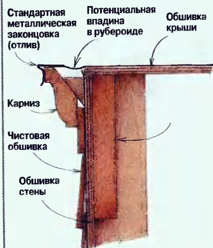
Рис. 8. Впадина между крышей и отливом — место скопления воды. Проставки для поддержки карниза могут создать впадины в подложке кровли. Стандартная металлическая законцовка (отлив) кровли не закрывает щель
