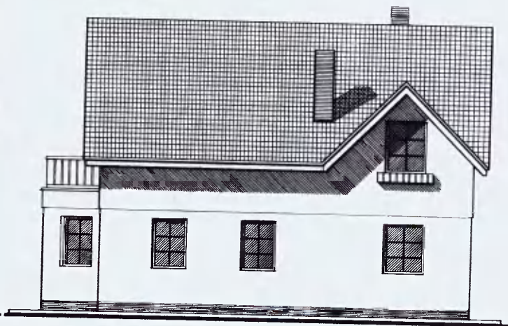
Боковой фасад с окном в спальню на втором этаже
