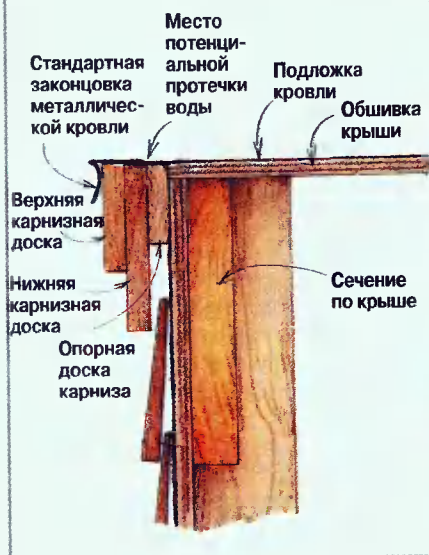
Рис. 6. Отлив металлической кровли недостаточно широк. При ширине верхнего фланца 45 мм стандартная законцовка металлической кровли может не перекрыть вертикальных стыков, образованных деталями карниза крыши и обшивкой стены. Эти стыки — потенциальные проходы для воды
